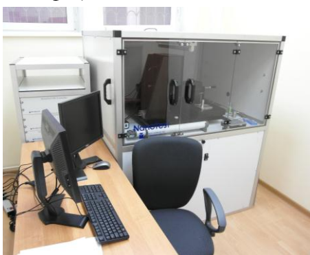
Рис. 3. Нанотвердомер «NanoTest 600» (Великобритания) для исследования механических свойств и кинетики релаксации напряжений материалов в нанометровом диапазоне
