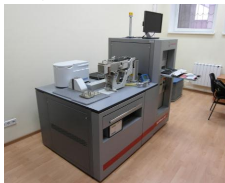
Рис. 2. Малоугловой рентгеновский дифрактометр SAXSess (Австрия) для исследования размера, формы и внутренней структуры нанобъектов (от 1 до 150 нм)
