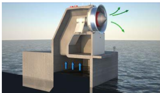
Рис. 4. Принцип действия гидротурбины Bluewave
