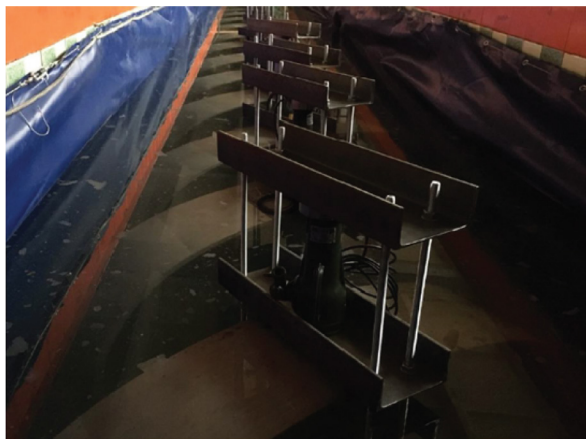
Рис. 2. Образцы труб, установленные в пространство лотка, заполненного водой
