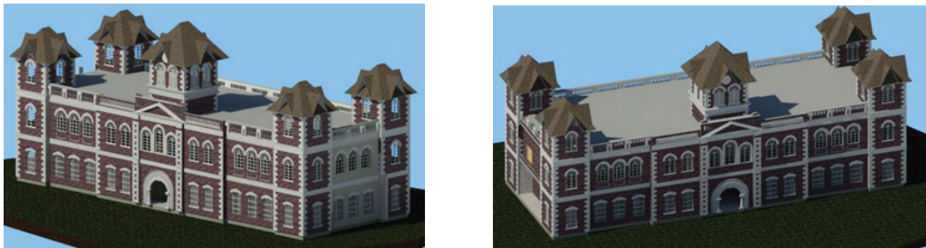
Fig. 10. 3D model of the Post Master General (PMG) office created from the point cloud data Рис. 10. 3D-модель офиса главного почтового управления, созданная на основе данных облака точек
