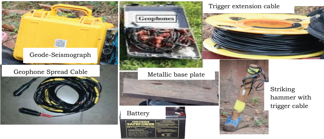
Fig. 5. MASW test setup — Equipments Рис. 5. Установка для многоканального анализа поверхностных волн — оборудование
