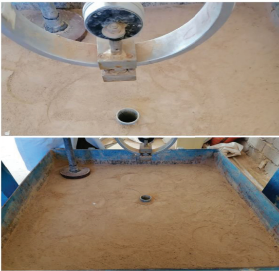
Fig. 4. Stone column inside PVC pipe Рис. 4. Каменный столб внутри трубы ПВХ
