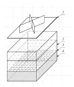
**Рис. 5.** Испытательный контейнер (металлическая коробка): I — металлическая крышка; 2 — слой основания (гранитный щебень М1000 фракции 20–40 мм); 3 — разделяющий слой из георешетки и листа белой бумаги в качестве индикатора для оценки заклинивающей способности каменного материала; 4 — дополнительный слой основания — песок средней крупности
