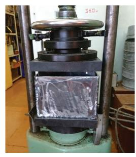
Рис. 4. Гидравлическая установка ЗИМ П-10
