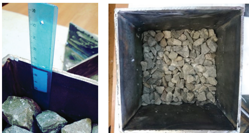
Рис. 7. Уложенный слой щебня на песчаный слой, слой бумаги и испытываемую георешетку
