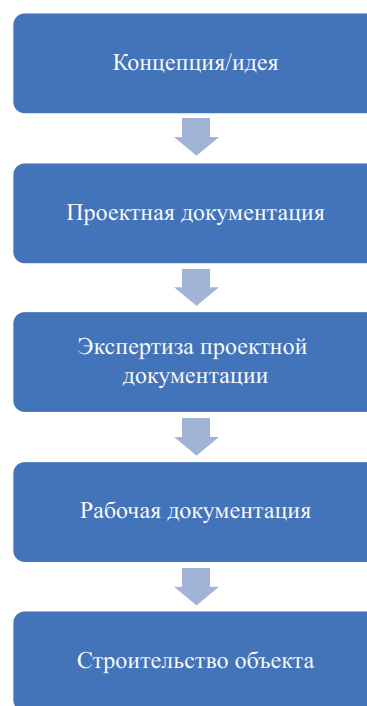
Рис. 1. Этапы жизненного цикла архитектурно-строительного проектирования
