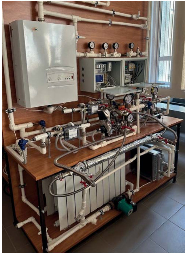
Рис. 7. Экспериментальная установка: a — схема; b — внешний вид; 1 — перелив; 2 — бак постоянного уровня; 3 — смешивающее устройство; 4 — электрический котел; 5 — клапан; 6 — циркуляционный насос; 7 — клапан; 8 — радиатор; 9 — измерительный сосуд; 10 — клапан; 11 — теплообменник для первичной подготовки воды; 12 — фильтр; 13 — устройство для измерения температуры; 14 — клапан
