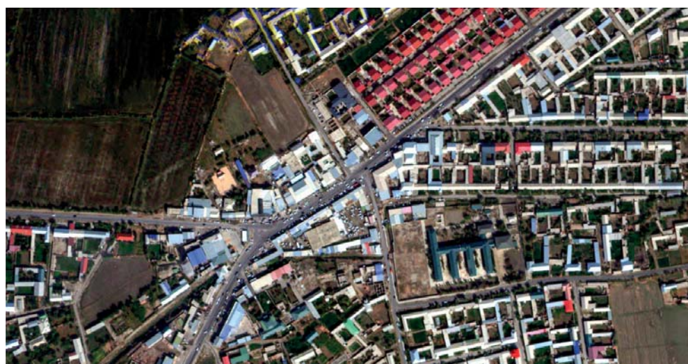
Рис. 3. Коммерческий российский спутник СТИЛСАТ с пространственным разрешением 0,5 м на пиксел. Оператор спутника — частная космическая компания СТИЛСПЭЙС
