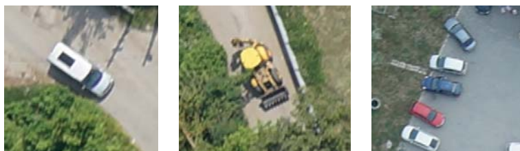
Рис. 12. Примеры увеличенных фрагментов цифровых аэроснимков, полученных с беспилотного летательного аппарата, с отображенной на них техникой
