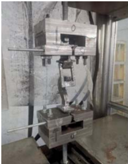
Рис. 5. Испытание образца на растяжение по данным X. Zou и соавт. [1]
