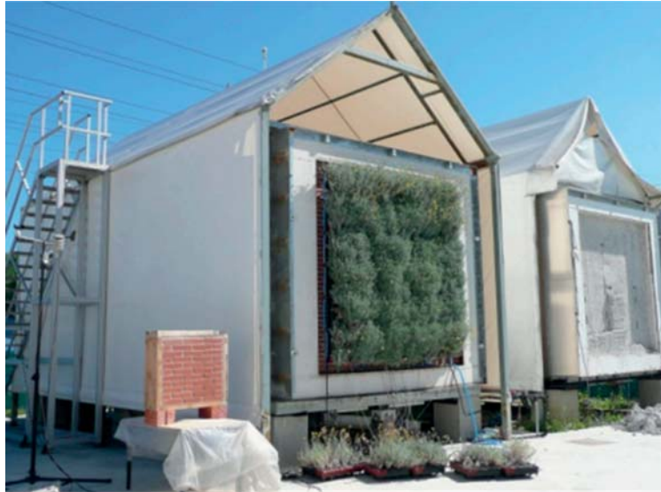
Рис. 11. Собранный модуль, тестовая ячейка PASLINK по данным Z. Azkorra-Larrinaga и соавт. [15]
