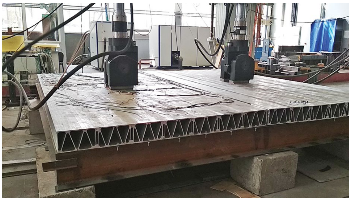
Рис. 7. Испытания спаренных ортотропных автодорожных плит из сплава EN AW-6082 T6 на статическое воздействие и выносливость
