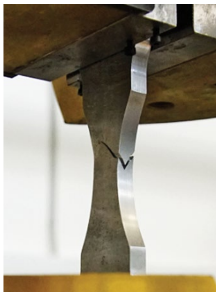
Рис. 5. Вид и результаты усталостных испытаний образцов сплава 1915Т
