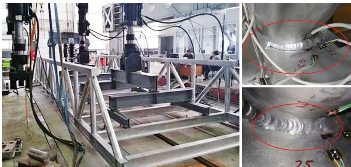
Рис. 6. Вид испытаний пешеходного моста из алюминиевого сплава 1915Т и образовавшиеся трещины в ожидаемых зонах
