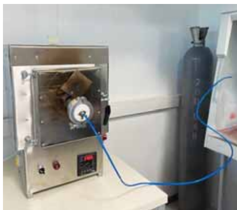
Рис. 1. Установка для термической обработки торфа
