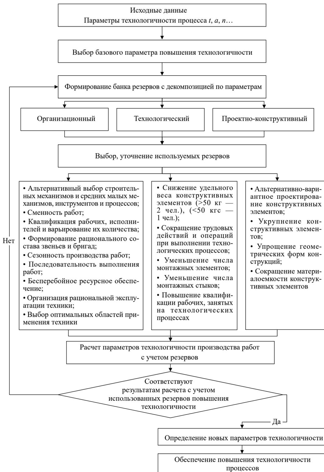
Рис. 1. Алгоритм формирования организационно-технологического механизма повышения технологичности
