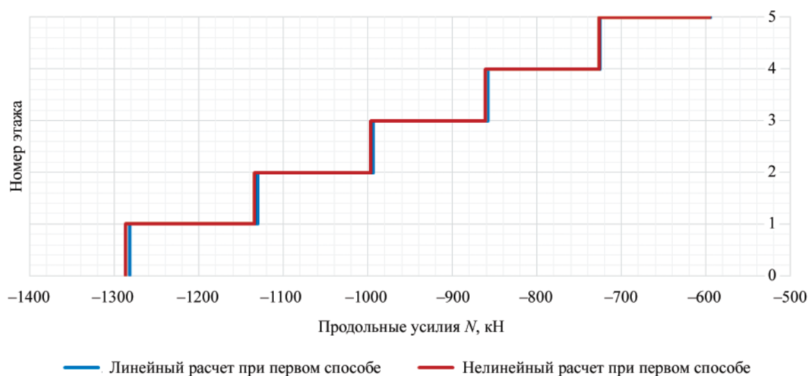
Рис. 6. Продольные усилия в средней колонне для 1–5 этажей при первом способе расчета от расчетного сочетания нагрузок усилий
