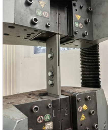
Рис. 4. Испытание образцов на растяжение в разрывной машине
