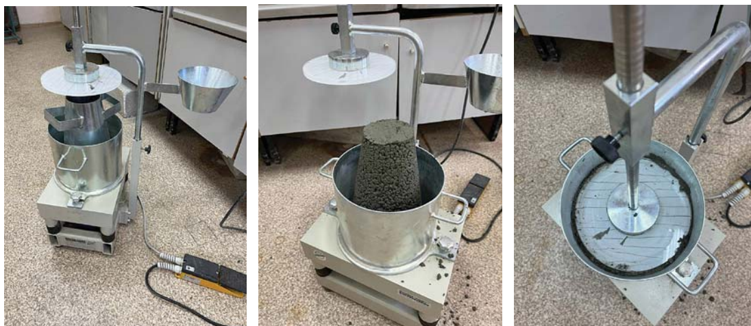
Рис. 3. Прибор Вебе для определения жесткости бетонной смеси
