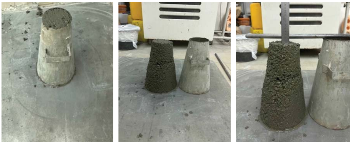
Рис. 8. Приготовление эталонной бетонной смеси с доломитовым заполнителем
