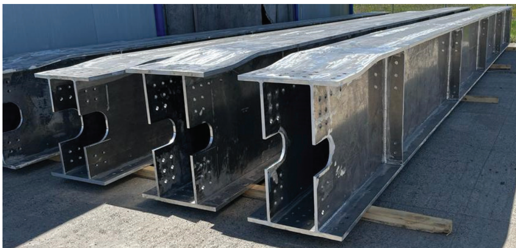
Рис. 14. Продольные несущие балки коробчатого сечения
