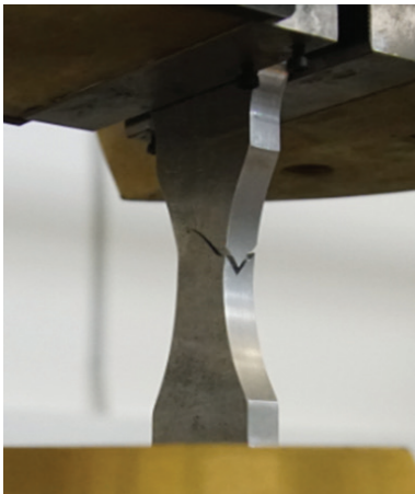
Рис. 6. Вид и результаты усталостных испытаний алюминиевого сплава 1915Т
