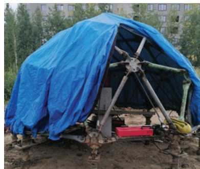
Рис. 3. Конструкция геокупола для статических испытаний грунтов сваями
