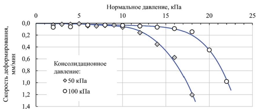
Рис. 5. Кривые сдвига при «срыве» по боковой поверхности
