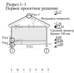
Рис. 6. Графическая реконструкция лавки, первое проектное решение 10
