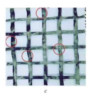
**Рис. 8.** Результаты экспериментальных исследований Армосет Б: a — общее состояние армируемой георешетки на слое рыхлого песка; b — состояние индикатора заклинки (бумага); c — повреждение извлеченной георешетки Армосет Б
