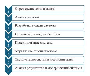
**Рис. 1.** Алгоритм работы с системой в рамках системотехники строительства
