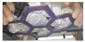
Рис. 11. Заклинивание каменного материала в инновационной 3D-георешетке
