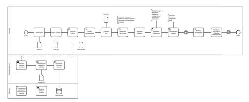
Рис. 3. ВРМN схема интеграции генеративного дизайна в ВІМ-процессы
