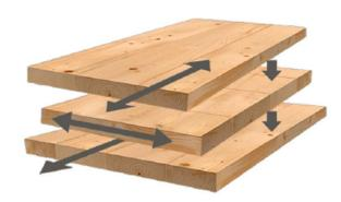
Рис. 1. Перекрестное склеивание панелей СLТ
