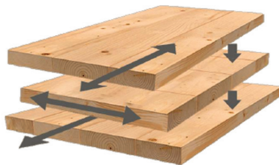
Рис. 1. Перекрестное склеивание панелей CLT
