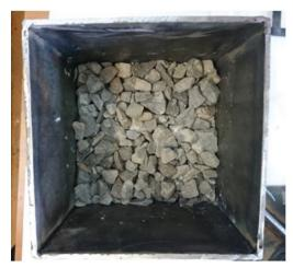
Рис. 7. Уложенный слой щебня на песчаный слой, слой бумаги и испытываемую георешетку
