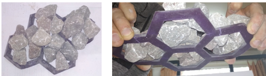
Рис. 11. Заклинивание каменного материала в инновационной 3D-георешетке
