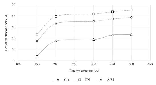
Рис. 4. График зависимости несущей способности тонкостенного стержня от высоты сечения
