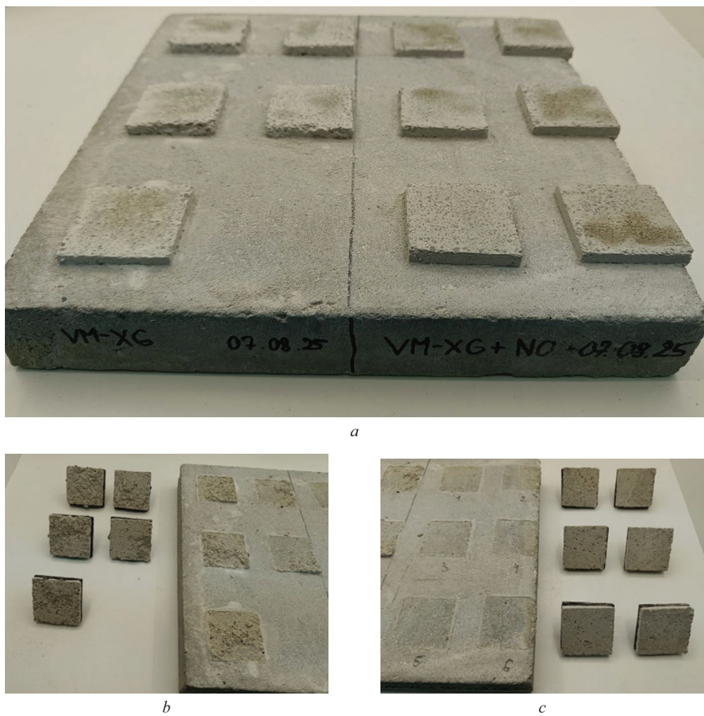
Рис. 2. Внешний вид образцов для определения прочности сцепления (адгезии) материала для АСП с бетонным основанием: a — перед приклеиванием штампов; b — после отрыва серии образцов с органической модифицирующей добавкой; c — после отрыва серии образцов с органической модифицирующей добавкой и гидрофобизатором
