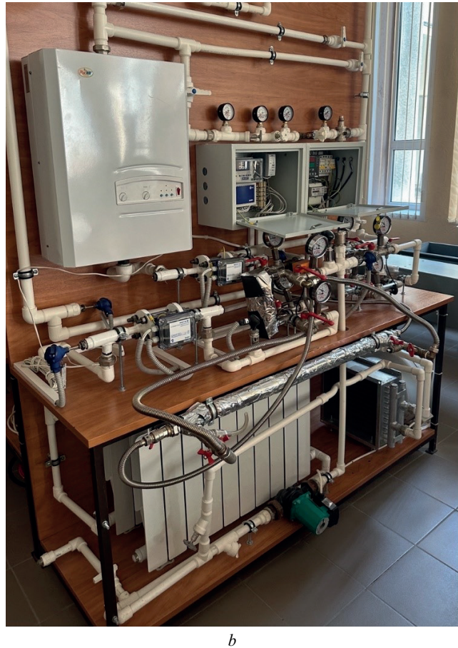
Рис. 7. Экспериментальная установка: a — схема; b — внешний вид; 1 — перелив; 2 — бак постоянного уровня; 3 — смешивающее устройство; 4 — электрический котел; 5 — клапан; 6 — циркуляционный насос; 7 — клапан; 8 — радиатор; 9 — измерительный сосуд; 10 — клапан; 11 — теплообменник для первичной подготовки воды; 12 — фильтр; 13 — устройство для измерения температуры; 14 — клапан
